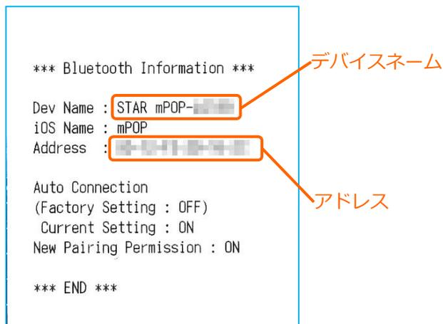
②レシートが3枚印刷されます。2枚目のレシートにプリンターで割り振られたDev Name（デバイスネーム）とアドレスが表示されます。
