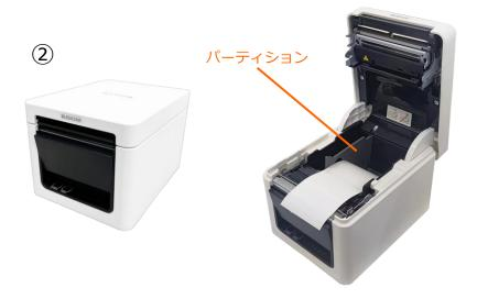
②プリンターへ【 パーティション 】を 差し込み、58mmのレジロールを入れて プリンターの電源を押しします。
