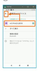
②ペアリングされた端末を確認します。 この画面に、レシートプリンターが表示されていれば、ペアリングを確認できます。
